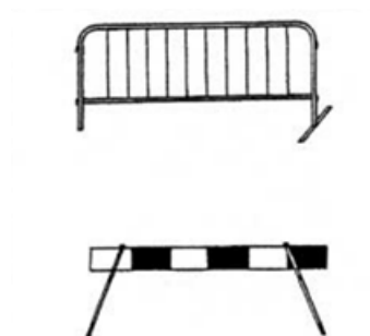
Ilustración 18 Vallado de señalización. Fuente: http://www.ibermutuamur.es/
