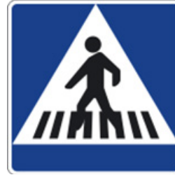
Ilustración 20 Señal Vertical S-13. Fuente: Norma 8.1 IC "Señalización vertical"
