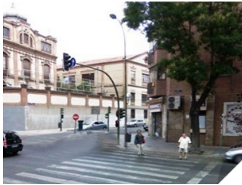
Ilustración 10 Con semáforo, pintado y sin refugio
