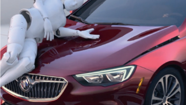
► Capó activo mediante la elevación del capó y airbag bajo el capó. Fuente: DPC Cars
