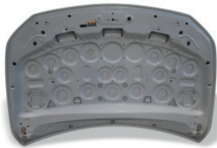
► Capó con estructura multicono del Mercedes A200
