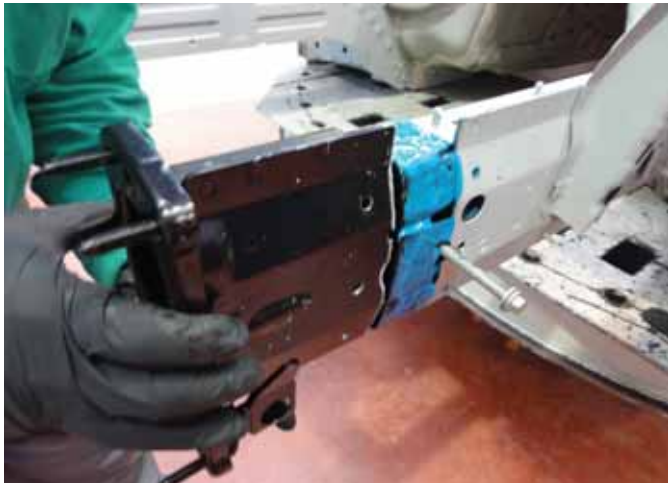
▀ Sustitución de piezas mediante pegado-remachado
