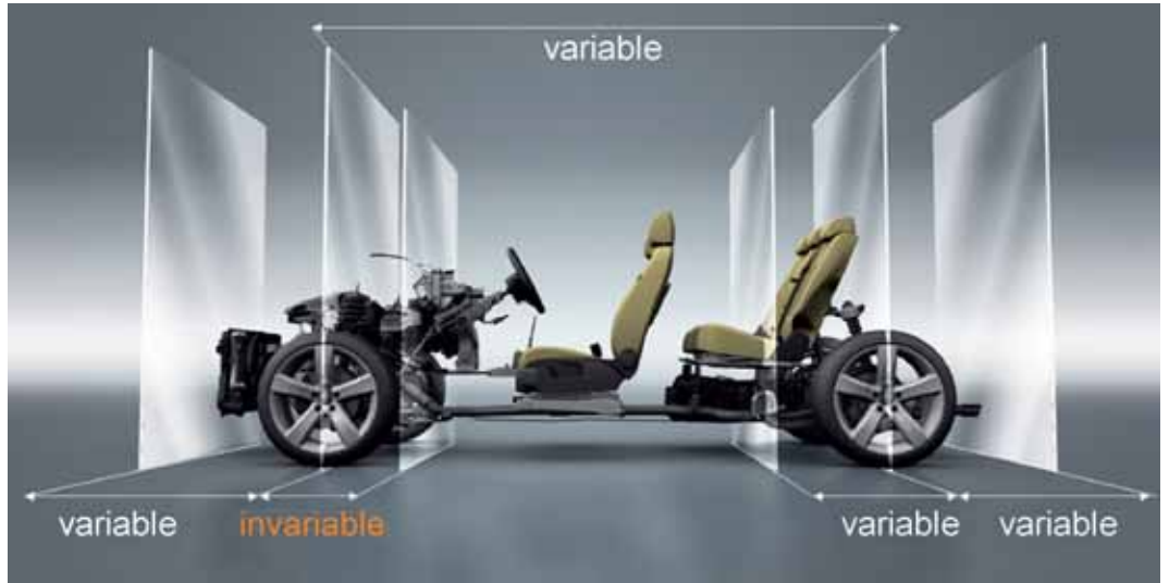
▶ Plataforma modular transversal (MQB) del grupo Volkswagen
