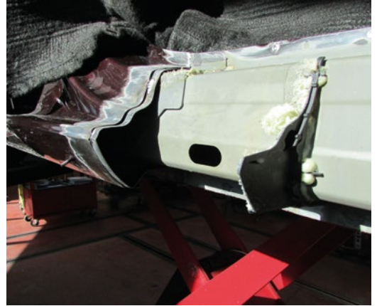
► Sustitución del estribo en sección
