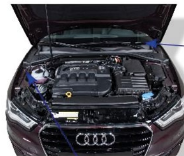
VIN: Troquelado en el refuerzo del pase de rueda delantero derecho
