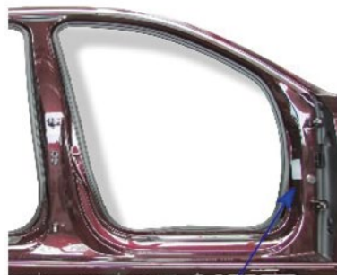
Placa del fabricante: Adhesivo pegado en el pilar derecho
