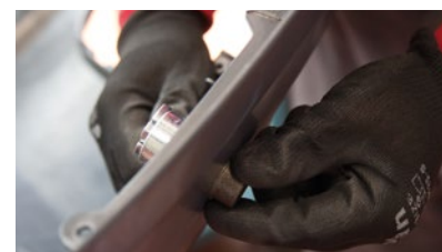
► Taladrado del paragolpes y alojamiento de los sensores de aparcamiento
