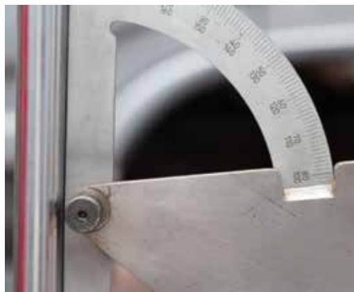
► Ángulo de caída del pivote de la mangueta
