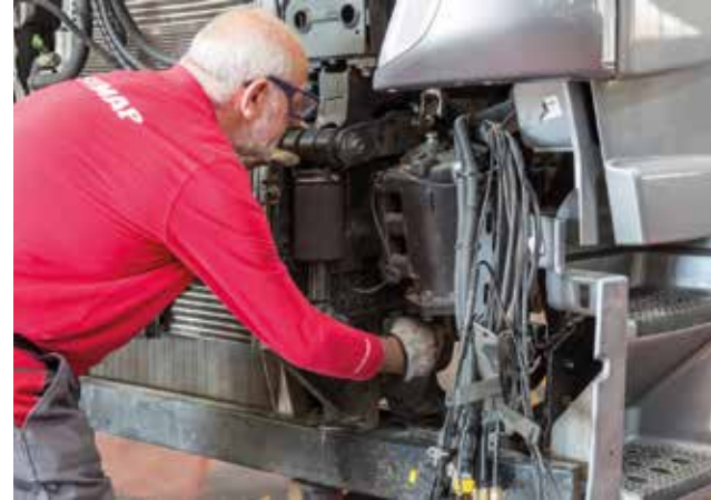
► Inspección de la caja de la dirección
