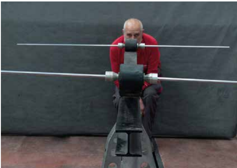
► Comprobación de la torsión de la ballesta
