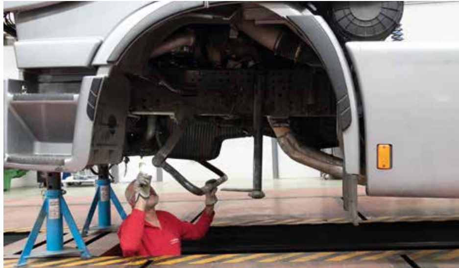
► Inspección de timonería
