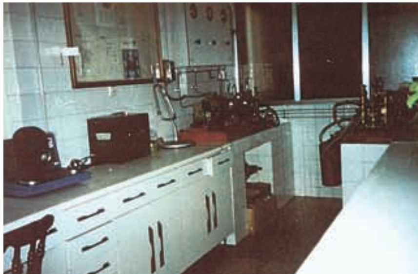
Taller de mantenimiento de equipos de respiración autónoma, dotado con: aparato de ensayo RZ 25; aparato de comprobación de mascarillas y de equipos de circuito cerrado; bombas de trasvase de oxígeno; botellas de aire comprimido, y repuestos.
