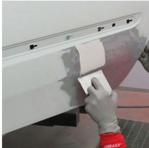
▸ Trabajos de pintura en reparación de daños estéticos
