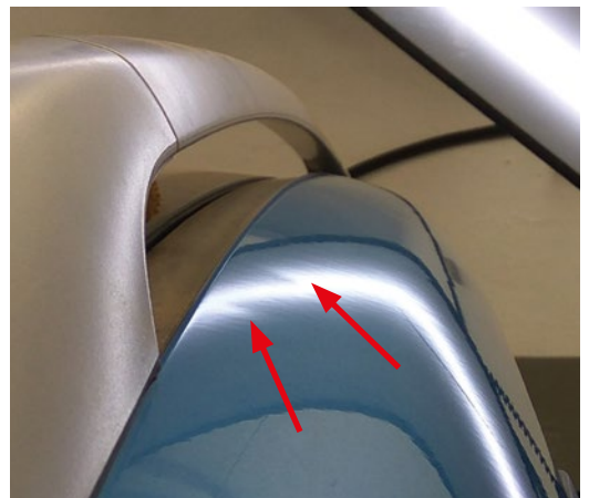
▶ Daños en el montante de techo
