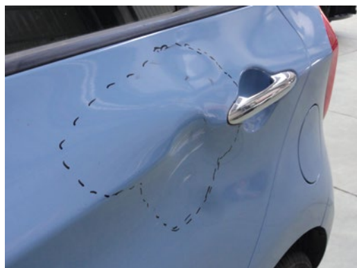
► Reparación de daño estético en puerta trasera
