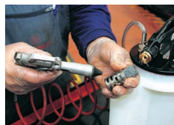
Limpieza del manguito
