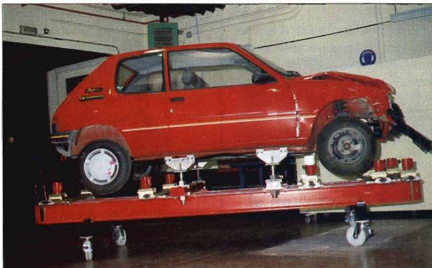
Disposición de mordazas de anclaje para el amarre del vehículo.
