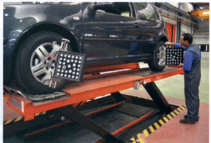
Colocación de los captadores ópticos
